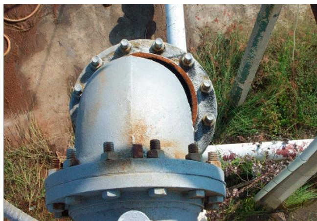
Figura 11.7 Ejemplos de fallas de aisladores cerámicos de equipo eléctrico y rotura de una tubería en una subestación eléctrica. Fuente: archivo personal de Sergio Alcocer (2003).
