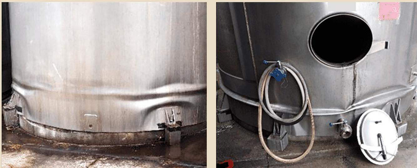
Figura 12.1 Fallas por pandeo local (izquierda) y pandeo total o falla de "pata de elefante" (derecha).
