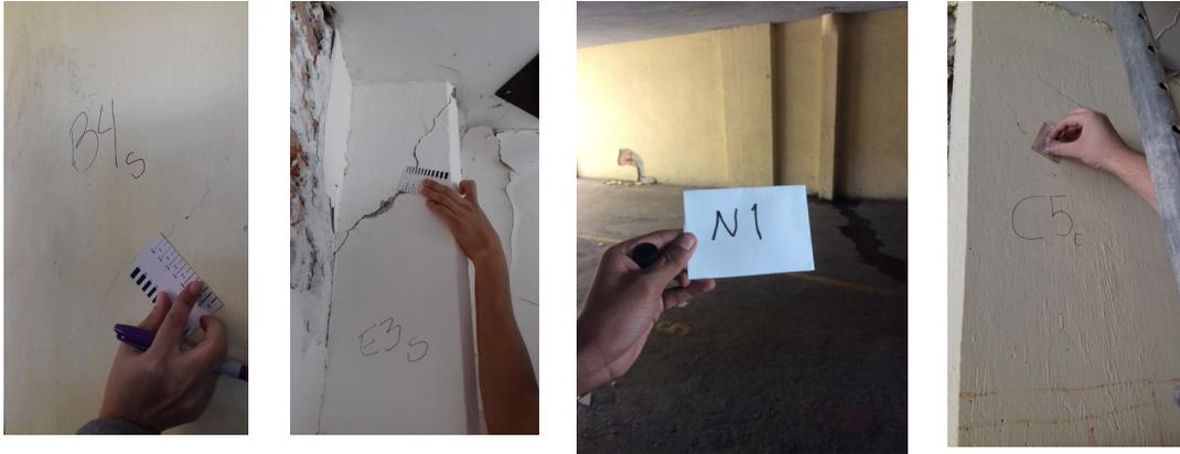
Figura D.2 Ejemplos de identificación de caras de elementos estructurales (columnas) y de medición del ancho de grietas usando comparadores manuales.
