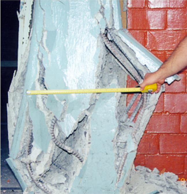
**Figura 3.10** Falla por flexión-tensión diagonal y posterior aplastamiento del concreto de la columna.
