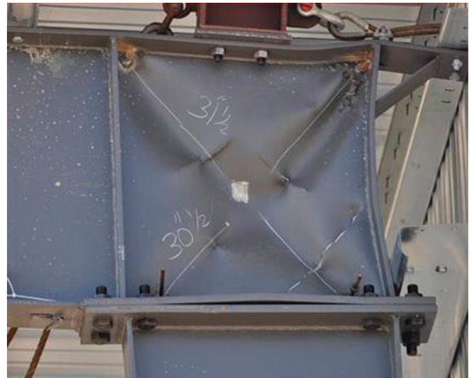
Figura 3.16 Falla por pandeo o rotura en zona de panel.
